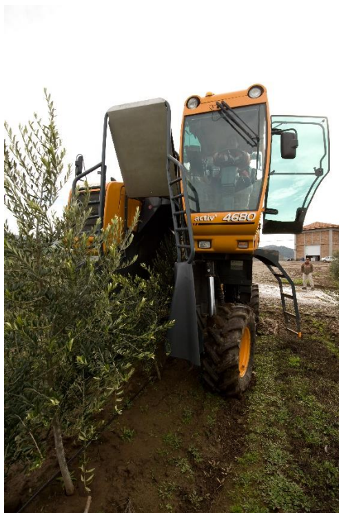
Figura 2. Cosecha Cabalgante de huerto super intensivo. Fuente Chileoliva.
