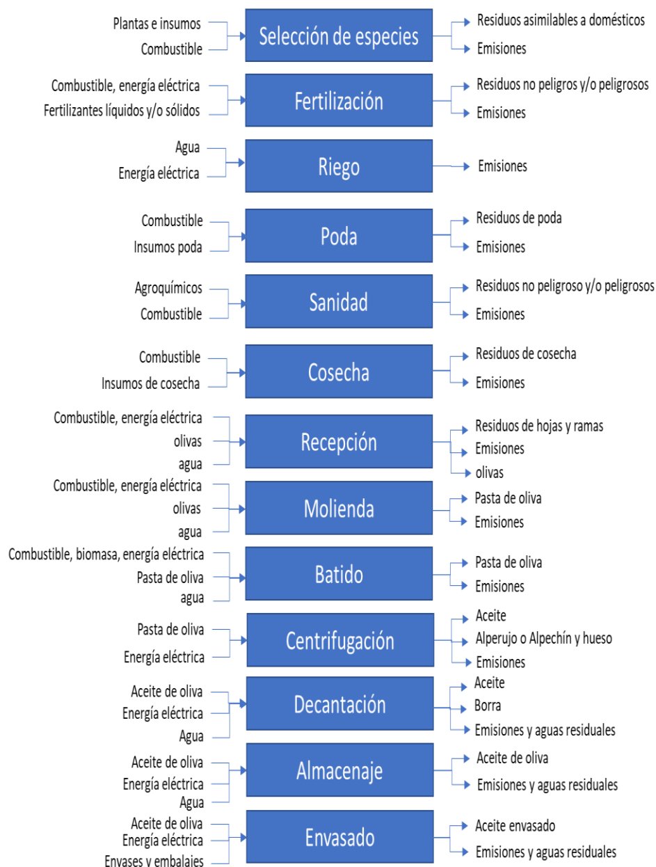
Figura 1. Diagrama del proceso de aceite de oliva. Fuente: Elaboración propia.
