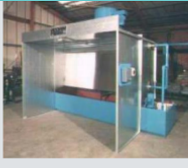
Cabina de pintado con cortina de agua. Fuente: IHOBE
