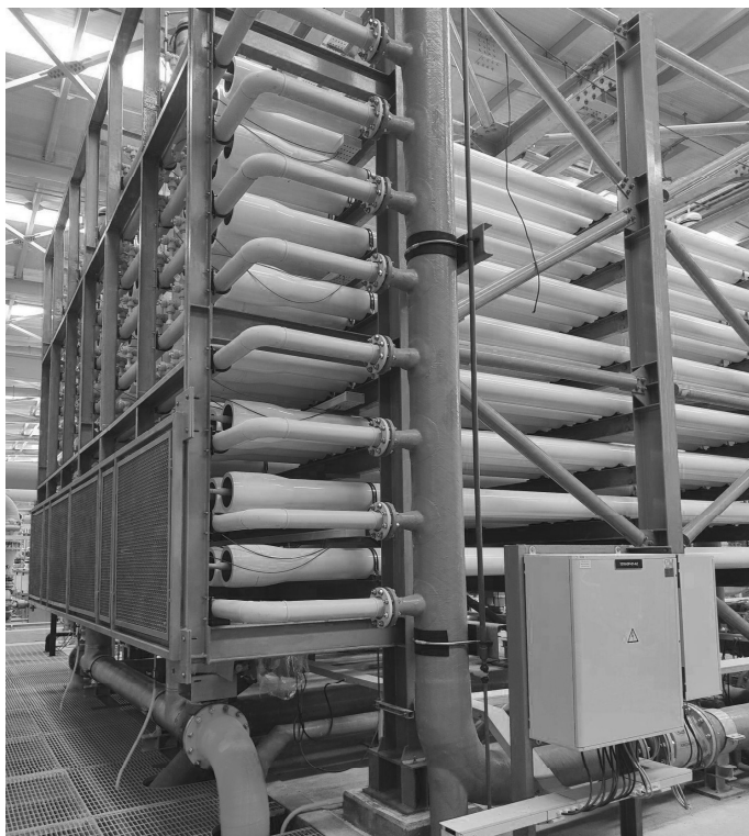
Figura 7. Configuración de módulo de membranas de ósmosis inversa en planta desaladora de Nueva Atacama (Caldera). Fuente: Autores
