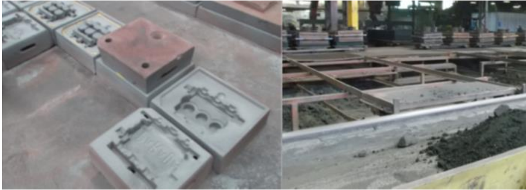
Figura 7 Producción de moldes y vista de línea automática
