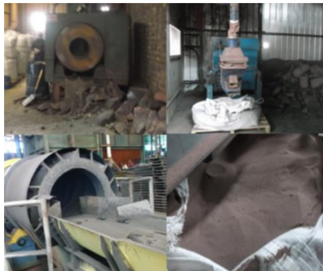
Figura 8 Ejemplos de sistemas de recuperación de arenas
