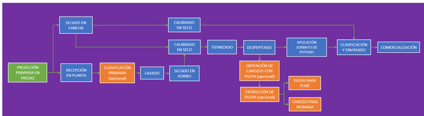
Figura 15. Flujo de proceso de producción de ciruelas deshidratadas. Elaboración propia.
